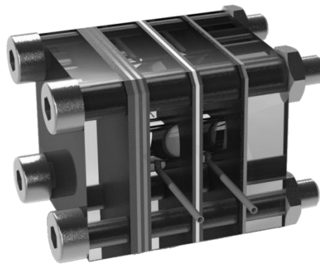
Abbildung 2: Darstellung der projektierten Messzelle. Aufgrund des mehrzelligen Aufbaus konnte der Sensorkopf exakt den Anforderungen des Systems angepasst werden. Größe des Sensorkopfes ~ 3 x 3 x 3 cm.
