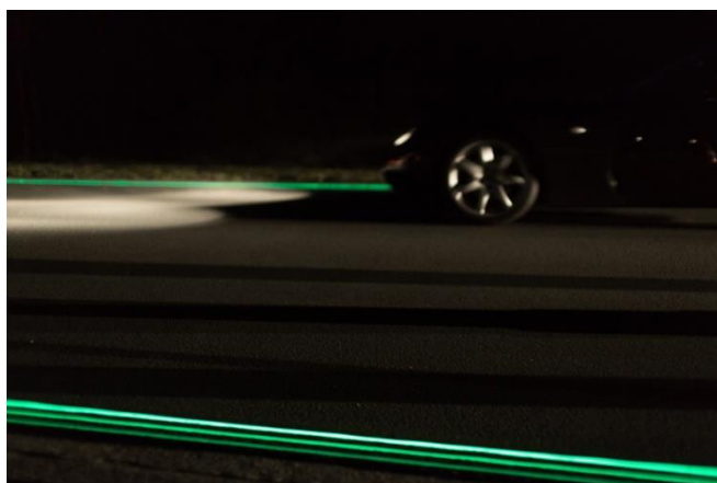
Abbildung 1: Foto der Glowing Lines - wie sie auf der Autobahn N329 in den Niederlanden getestet werden - des von dem niederländischen Designer Daan Roosegaarde und dem Unternehmen Heijmans BV entwickelten Projekts Smart Highway (© Studio Roosegaarde). 3
